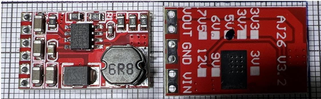
DC-DC Spannungsconverter - Step-Down Regler
