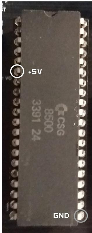
Dazu wird die Spannung zwischen Pin 6 (+5V, weißer Kreis) und pin 21 (GND) an der CPU (6510/8500) gemessen, die ca. 4.8-5.1V betragen sollte.
