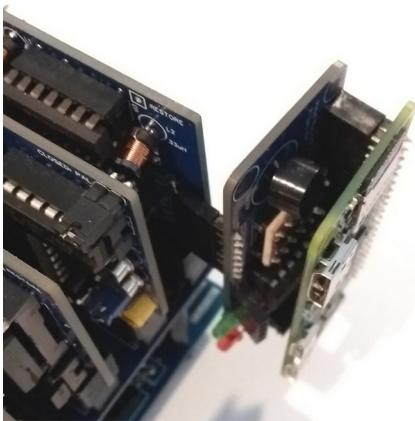
Damit die interne Pi1541 zuverlässig funktioniert, sollte der CIA 6526 (U8) Sockel auf der Rückseite möglichst mit einem CSG 6526/216A bestückt werden. Zwar sollen laut einem User auch MOS 6526/216A funktionieren, doch bei meinen Tests hatte ich schon Probleme mit MOS 6526/216A Chips. Ausserdem sollten die folgenden Dateien auf der SD-Karte des Raspberry Pins geändert werden.
