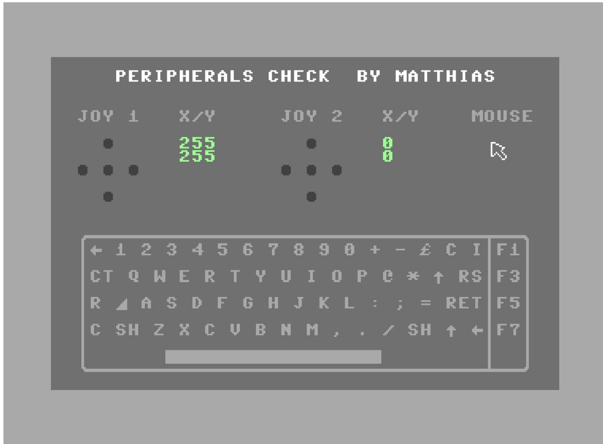
Mit diesem ROM-Programm kann zum ersten Mal die Tastatur und die Joystick-Ports zusammen auf einem Bildschirm getestet werden. Auch der Test einer Maus in **Joystick-Port 1** ist dabei möglich.
